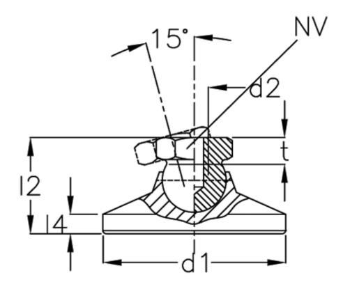
d1 = 40 d2 = 10 l2 = l4 = -NV = 15 Static load (kN) = 20 t min = 10.5
